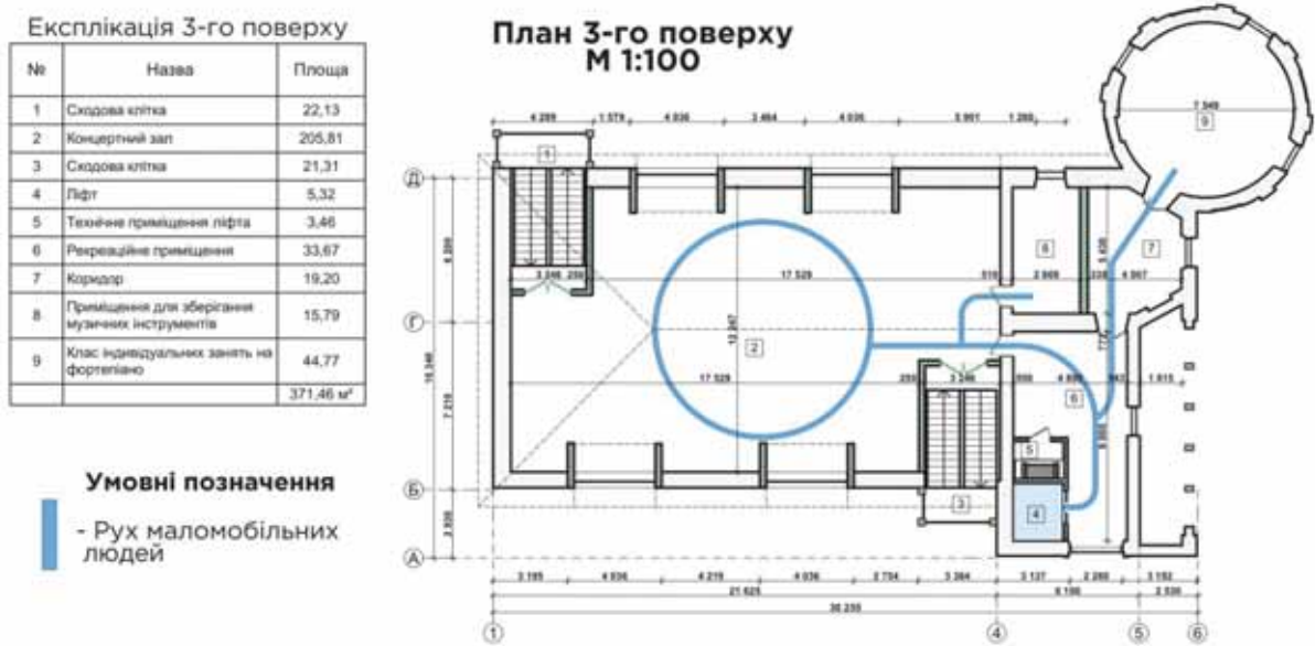
Рис. 6. Проект ревіталізації палацу Страхоцьких під музичну школу у м. Мостиська Львівської області. План третього поверху з організацією горизонтальних та вертикальних комунікацій руху маломобільних. Архітектор А. Степанюк
