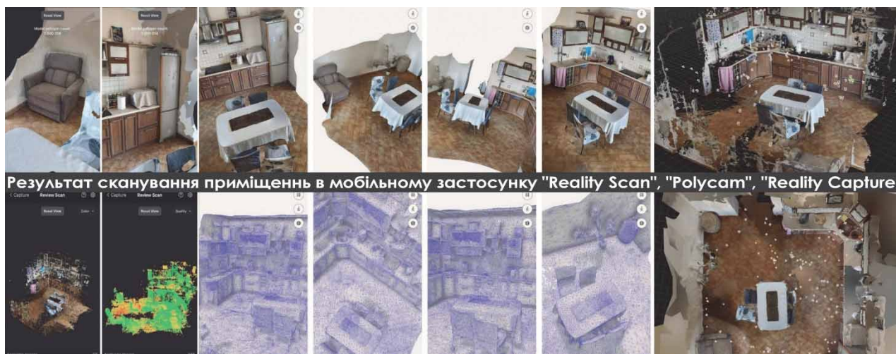
Рис 4. Результат сканування приміщення кухні в програмах для мобільного застосунку: Reality Scan, Polycam, Reality Capture. Студентка гр. ДАС-454 Домошей О.І.
