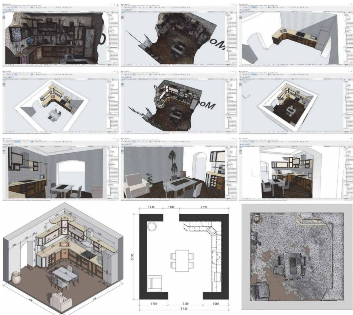
Рис 5. Процес відбудови приміщення кухні в програмі ArchiCAD на основі об'єму сканованої моделі. Студентка гр. ДАС-454 Домошей О.І.
