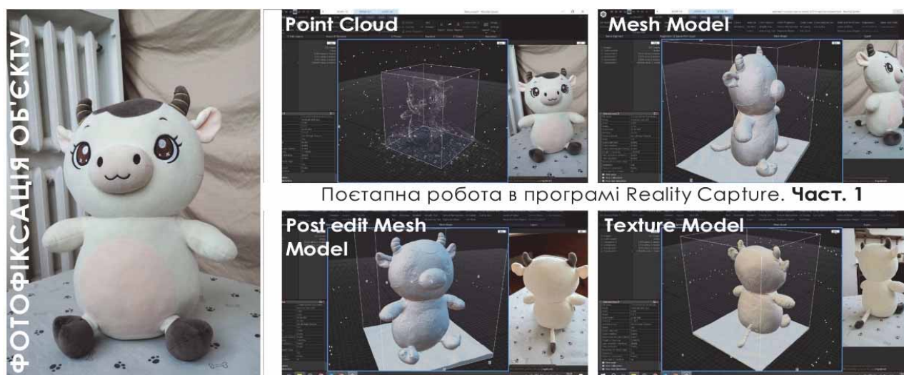
Рис 1. Поетапна робота в програмі Reality Capture та Blender на основі 3D-сканування
